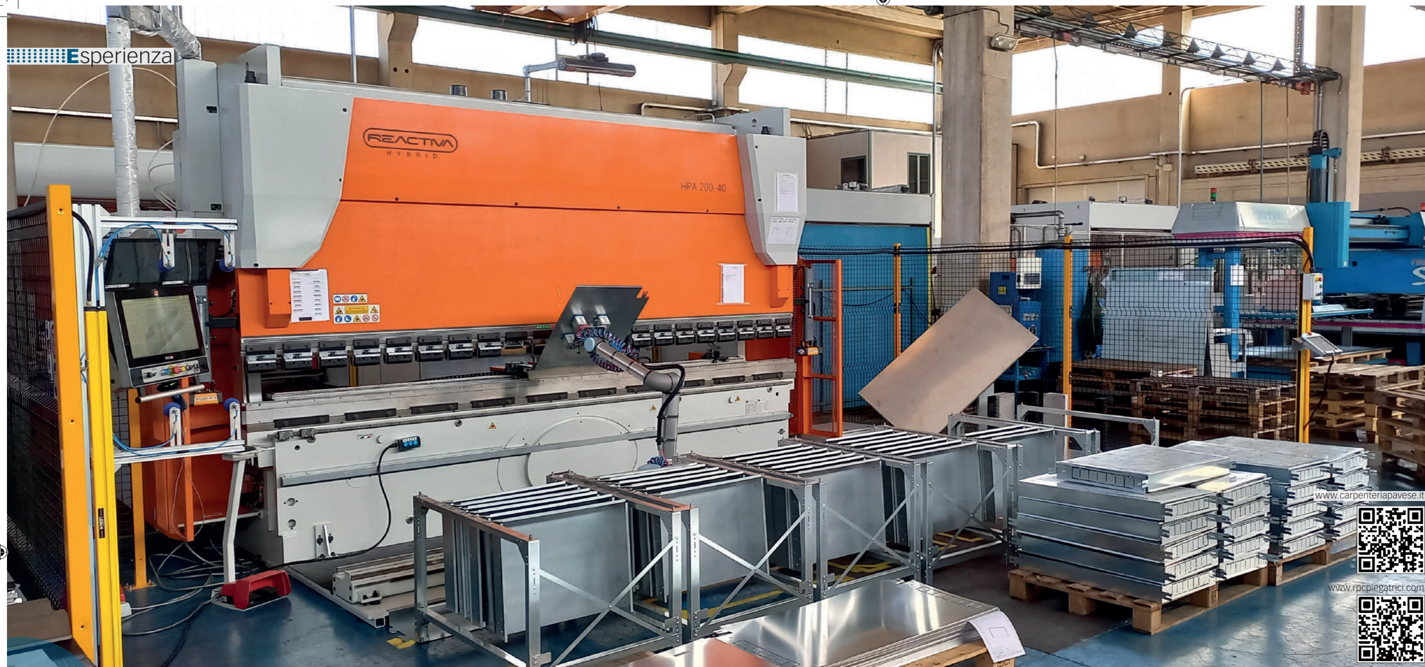
Grazie a un sistema di triplo monitor l'operatore della pressa piegatrice ha accesso a tutte le informazioni necessarie a gestire la commessa in formato digitale e sempre aggiornato.
