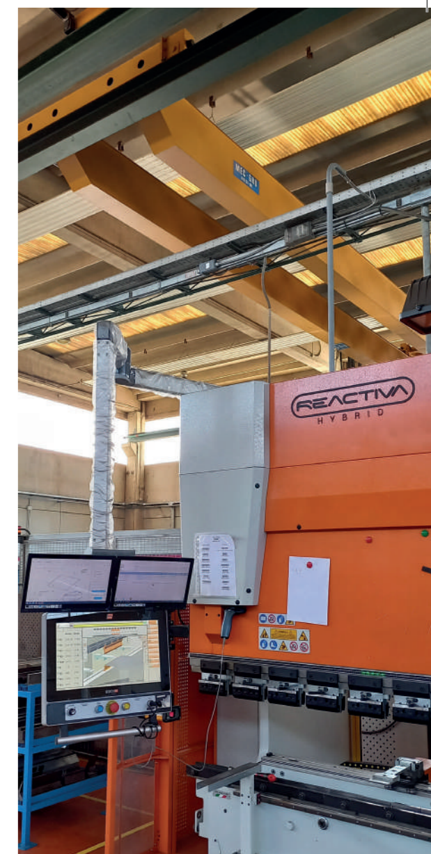
Grazie a un sistema di triplo monitor l'operatore della pressa piegatrice ha accesso a tutte le informazioni necessarie a gestire la commessa in formato digitale e sempre aggiornato.
