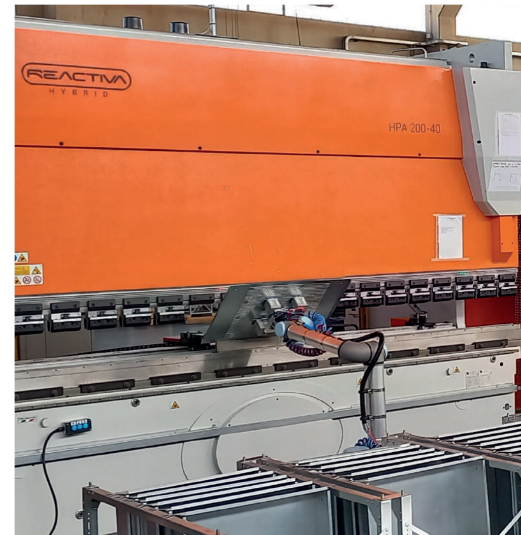
La piegatrice Reactiva HPA 200-40 è stata dotata di cobot Universal Robots dando vita a una vera isola di piegatura robotizzata.
